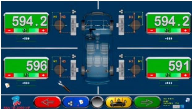
Höhenstandsmessung mittels speziellen Reflektoren Ride height measurement with dedicated targets Misura delle altezze telaio con Mini-target dedicati
